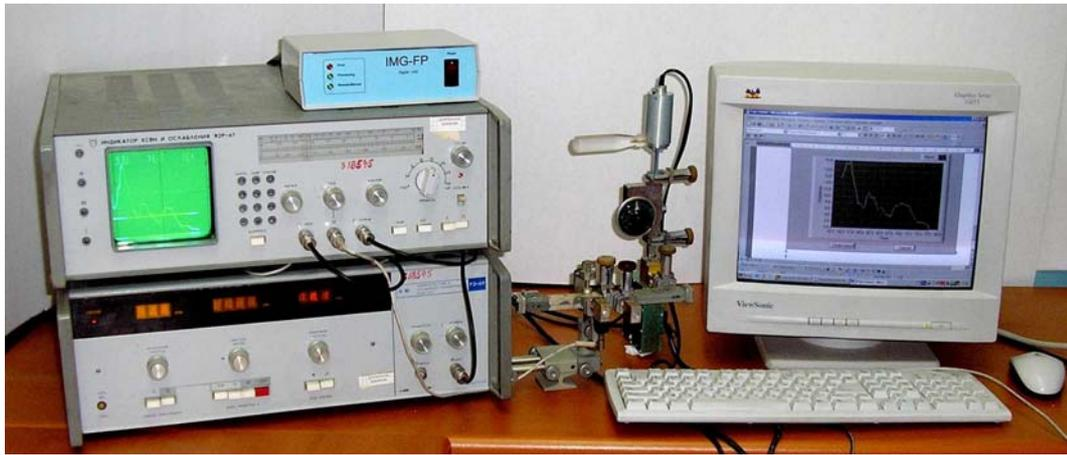
**Модуль СВЧ смесителя – преобразователя частоты** представляет собой волноводный балансный смеситель на диодах Шоттки диапазона 52-78ГГц с усилителем промежуточной частоты (УПЧ) в полосе частот от 100МГц до 400МГц. Модуль работает в двухполосном режиме с эквивалентной полосой ПЧ ~ 600МГц. Модуль снабжен автономным АС/DC блоком питания 220/12В.
