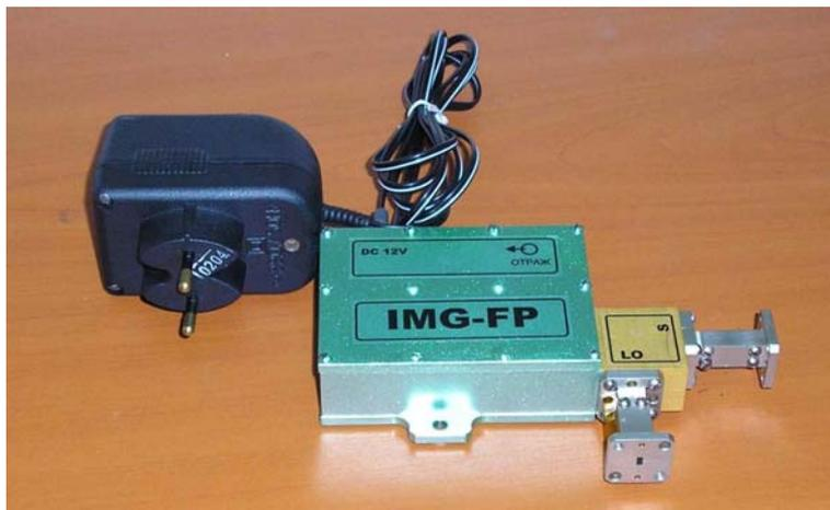
Установка для измерения частоты и мощности непрерывных сигналов используется в составе панорамного измерителя КСВ и ослабления (P2-69) и предназначен для измерения, обработки и сохранения в оцифрованной форме параметров амплитудно - частотных характеристик медико-биологических приборов КВЧ диапазона.
