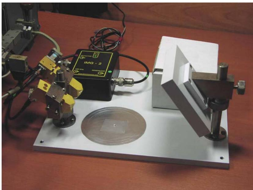
Лабораторная установка умножителя частоты используется в составе панорамного измерителя КСВ и ослабления Р2-69, предназначена для медико-биологических исследований.
